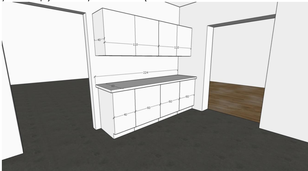
Rys. 2 Koncepcja zabudowy – ściana wewnętrzna
