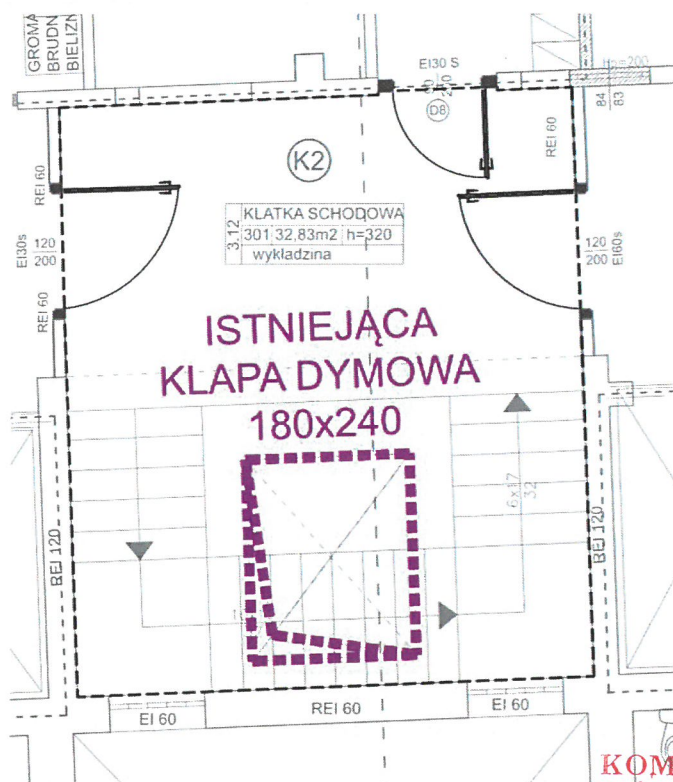
Rys. 9. Rzut ostatniej kondygnacji w obszarze klatki schodowej K2 wraz z lokalizacją klapy dymowej na dachu.
