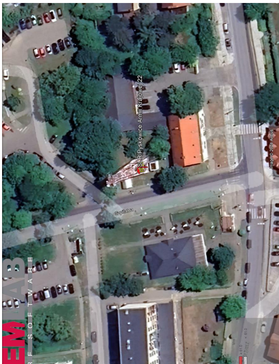
Rys. 2. Rzut poziomy rozkładu pola elektromagnetycznego anteny nowo projektowanej linii radiowej w otoczeniu SLR Pyskowice przewidzianej do zainstalowania na wysokości 39,5 m nad poziomem terenu.
